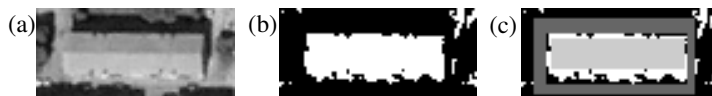
Figure 7. Zone d'incertitude introduite dans la TTR en (c) pour détecter un bâtiment n'étant pas parfaitement rectangulaire (image originale en (a) et image binarisée en (b)). La position possible de l'ES de l'objet apparaît en gris clair tandis que celle de l'ES du fond apparaît en gris foncé. Entre ces deux zones, ce n'est ni purement du bâti (pixels blancs), ni purement du fond (pixels noirs).
