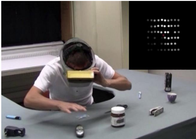
Fig. 4. : Expérience de simulation de neuroprothèse visuelle. Le casque de réalité virtuelle affiche la scène visuelle telle qu'elle serait perçue par une personne non-voyante implantée avec une neuroprothèse visuelle (image en haut à droite). La tâche à effectuer consiste ici à saisir un objet précis sur la table.
