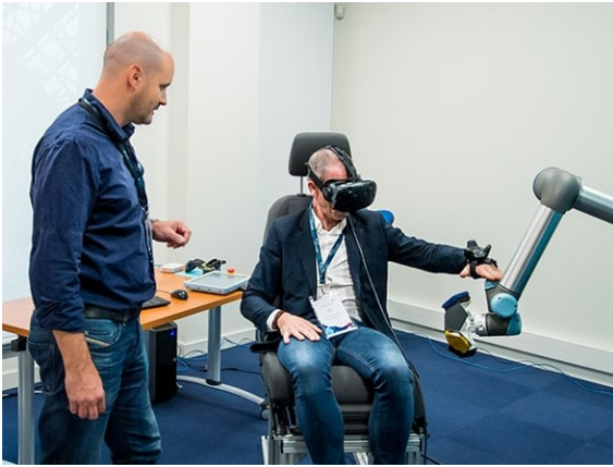
FIGURE 42 – Le projet Lobby-Bot, dans lequel un bras robotisé vient positionner une surface congruente en position, orientation et texture avec une surface présente dans l'environnement virtuel
