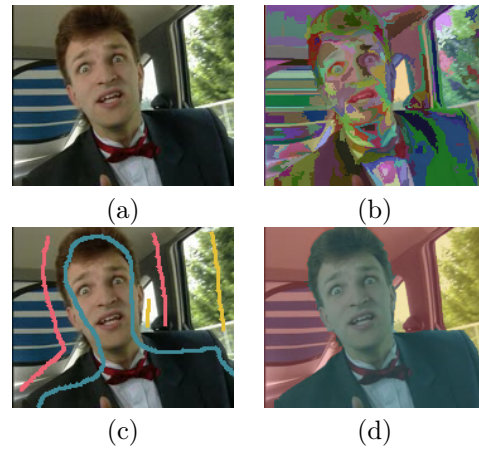
Figure 2: Illustration du processus de segmentation avec les résultats obtenus sur la trame 186 : a) trame originale, b) sur-segmentation initiale, c) marqueurs, d) segmentation finale.
